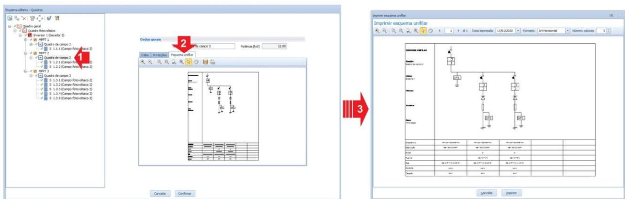
Finalizada a fase de modelagem, é possível visualizar o **esquema unifilar do sistema** seleccionando o **"Quadro Geral"** e clicando no botão **"Esquema unifilar"** presente na caixa das ferramentas do menu **"Desenho"**.
