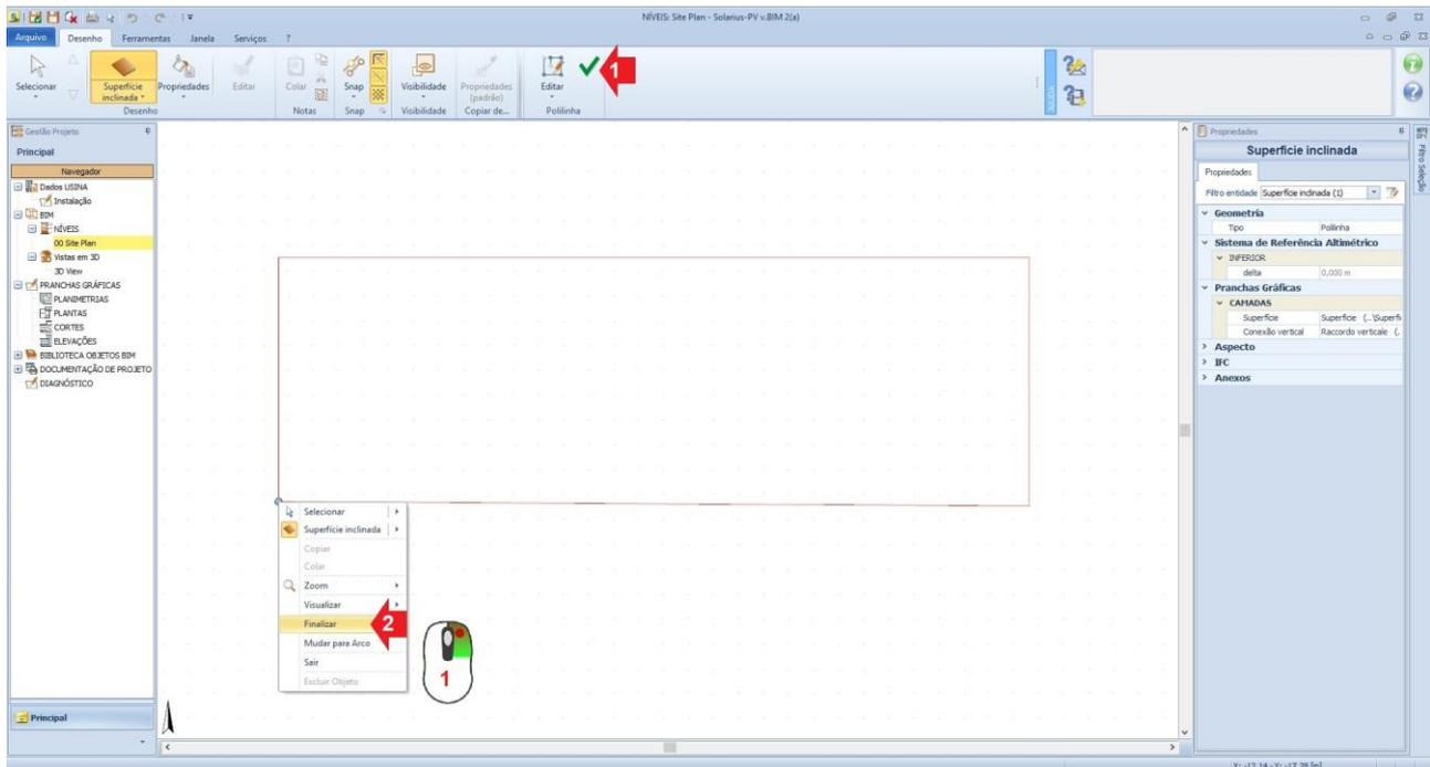
Finalizada a operação, se ativa de forma automática a vista **"Editor da superfície inclinada"**, onde **É NECESSÁRIO definir a área de instalação do campo fotovoltaico** e a possível inclinação da superfície.
