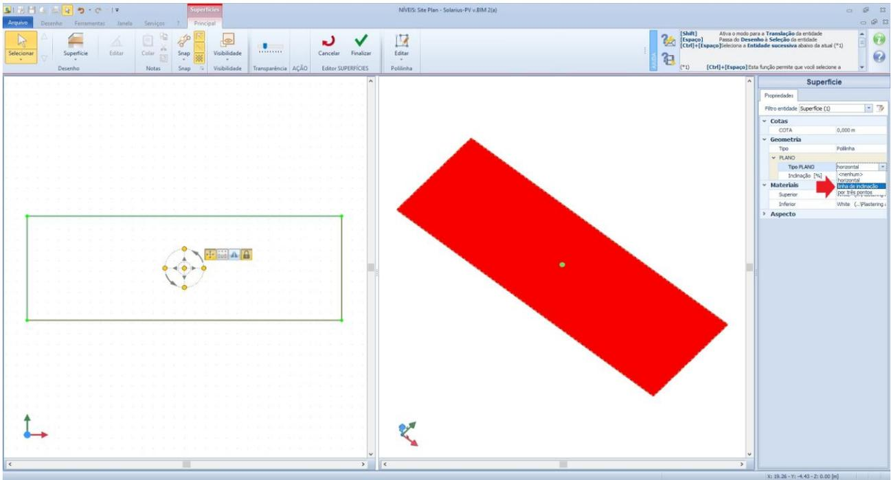
Os pontos **P1** e **P2** são colocados manualmente ao longo dos lados da superfície a partir da janela à esquerda. Para pegar nos pontos P1 e P2, é necessário utilizar o zoom do mouse (*roda do mouse*) e colocar os próprios pontos na correspondência dos vértices.
