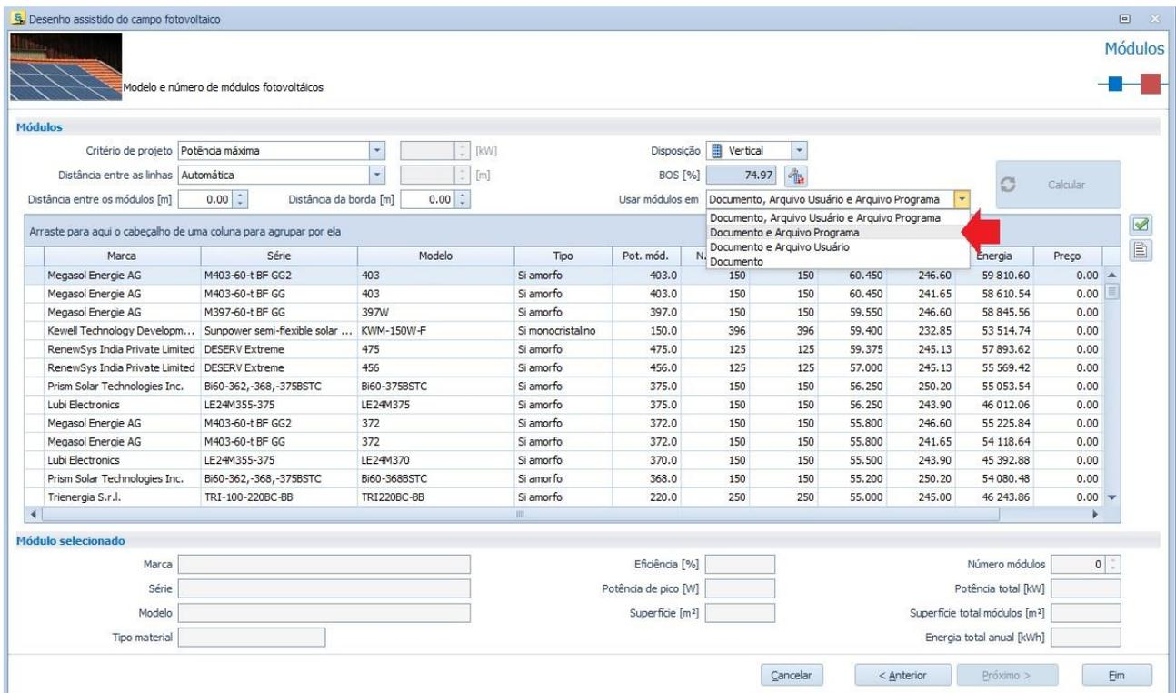
Selecionado o módulo a ser utilizado no projeto, você pode finalizar o desenho assistido do campo fotovoltaico, assim obtendo o posicionamento do campo fotovoltaico de acordo com os critérios escolhidos nos passos anteriores.
