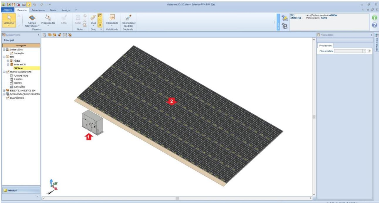
**Outro objeto a ser posicionado para completar o projeto fotovoltaico** é o Quadro Geral, além dos possíveis sob quadros em CA e CC. Utilizando o objeto BIM “**Quadro Geral**”, você pode colocar o objeto no desenho. Selecionado o objeto, você clica no botão “**Projetar Quadros**”, na caixa das ferramentas, assim ativando o “**Wizard**” para escolher as proteções de entrada e saída, bem como o dimensionamento automático dos cabos. As imagens a seguir mostram os vários passos do Wizard.
