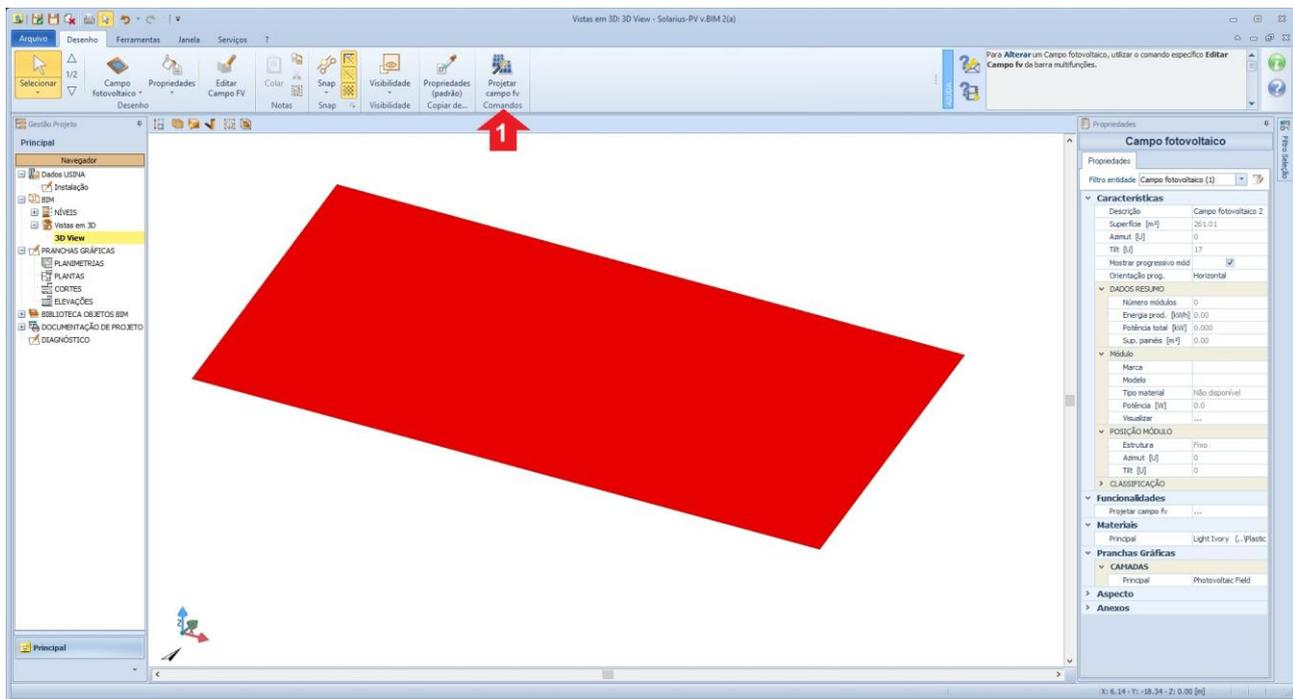
**No primeiro passo do Wizard** é possível escolher um sistema fotovoltaico complanar ou não à superfície desenhada. Se optar pela opção **“complanar”**, você pode escolher entre várias opções, por exemplo “Móvel com um eixo horizontal”, “Móvel com um eixo vertical”, “Móvel com dois eixos” (2).
