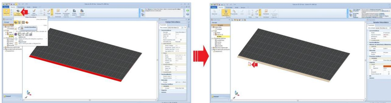
Colocado o objeto BIM "Gerador fotovoltaico", é preciso ativar o "Wizard" (clicando no botão específico mostrado no ponto "2" da imagem a seguir) para escolher e atribuir o inversor compatível ao campo fotovoltaico.
